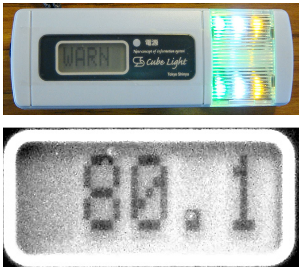
写真-2 現場内通報器(受信機)表示例
