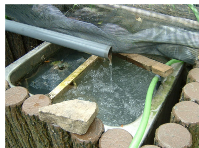
図－3 微生物資材を投入した小型槽
