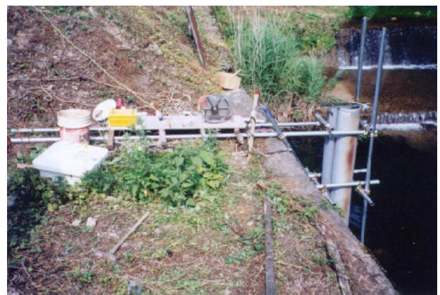
写真-1 改造した水位計
