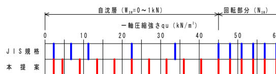
図-3 一軸圧縮強さの強度段階比較
