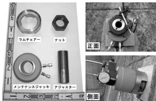
図-2 サームジャッキ構成要素と設置状況
