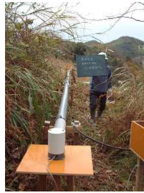
写真-2. 伸縮計設置状況
