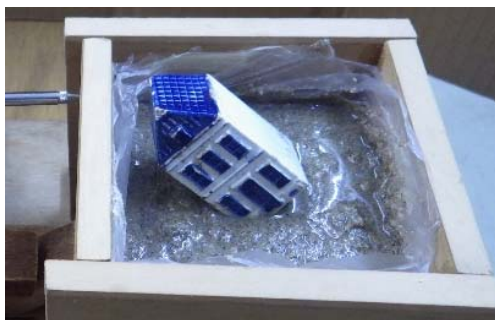
写真-5 実験2により発生した液状化
