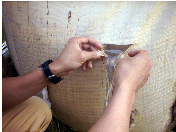
写真三 トンパックでの凝集分離状況
