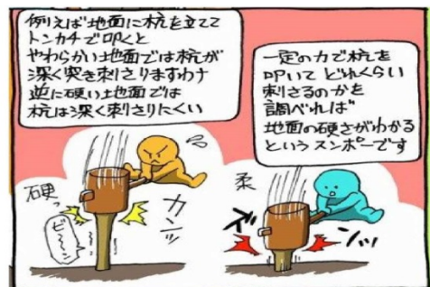
図-6 土の強さを示す N 値説明図 2)
